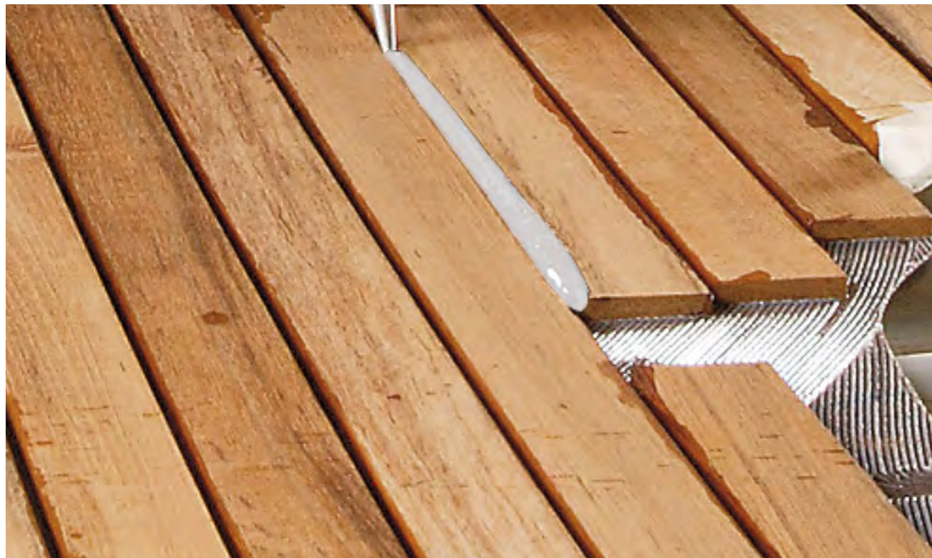
Mit Dispersionsklebstoffen werden zum Beispiel Schiffsdecks aus Holz verleimt. Hier ist die Wasserbeständigkeit des Klebers gefordert.
